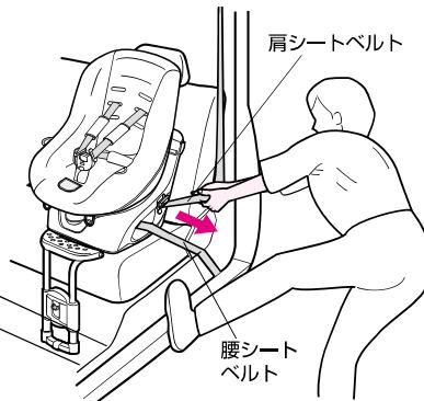
ドアが開閉しない座席の場合 (3ドア車、3列目シートなどに取付けする場合)
