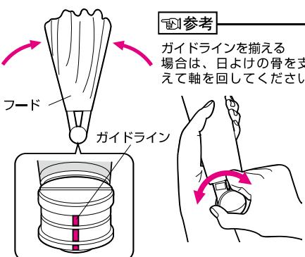
3 日よけのフードをたたんだ状態で、本体カバー側面の穴に軸を通す。
