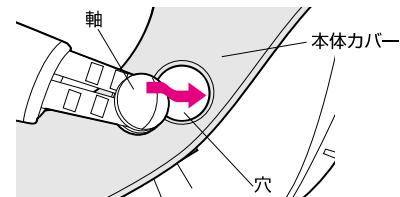
2 本体カバー側面のフックを外してカバーをめくる。
