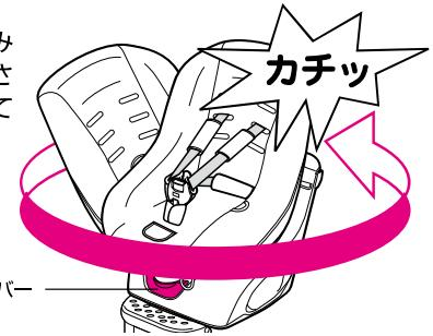
リクライニングを3段目の位置にして、ターンレバーを手前に引きシートを回転させる。
