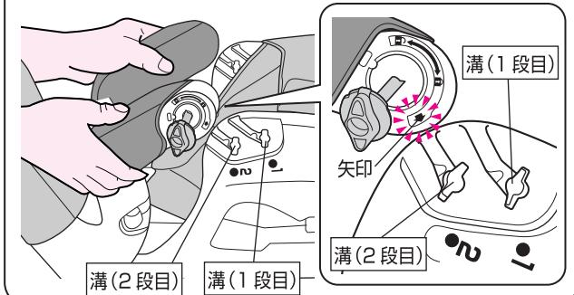
**16** 左右の角度調節パーツの青色の矢印を背もたれの溝に沿って押込みます。
