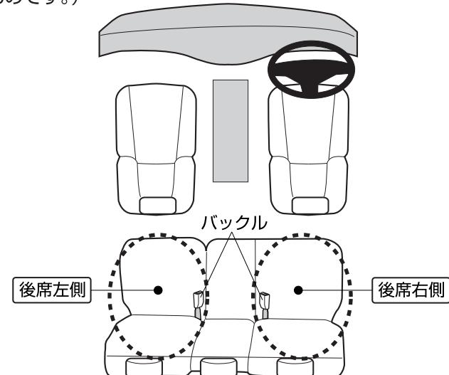
●取付けの際に使用するバックルがある方をバックル側、その反対側をベルトストッパー側と呼んでいます。
