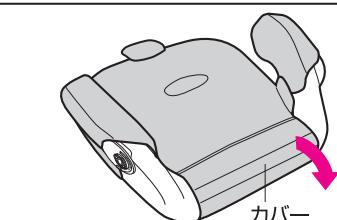
**7** 座面後ろのカバーを下に倒します。
