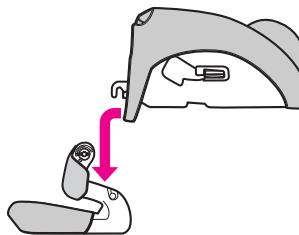
**15** 左右の角度調節パーツにある青色の矢印を背もたれの溝(1段目または2段目)と合わせます。
