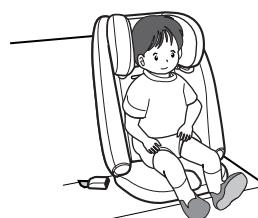
両側のベルト通し部に腰シートベルトを通して、タングをバックルに力チッと音がするまで差込みます。
