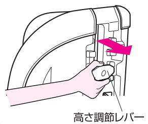
**2** 高さ調節レバーを引いたままもう片方の手でヘッドレストを動かします。
