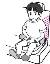
**3** 兩側のベルト通し部にシートベルトを通し、タングをバックルにカチッと音がするまで差込みます。バックル側の肩シートベルトもベルト通し部の下を通してください。
