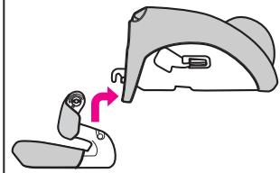
5 座面側面(左右2ヶ所)と後側(2ヶ所)にある、カバーのピンを外します。
