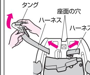
10 座面カバーを座面にかぶせ、バックルとハーネスをカバーの穴に通します。
