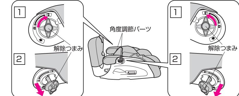
3 本体正面で背もたれと座面の間から手を入れ、背もたれカバー内側の面ファスナーを外し、座面を背もたれと水平になるまで倒します。
