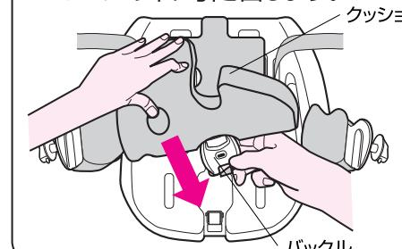
14 バックルを前に倒し、座面の穴へ収納します。
