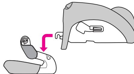
16 ハーネスハンガーのベルトを突起の下を通し、ハーネスを収納した穴の前の位置に置きます。
