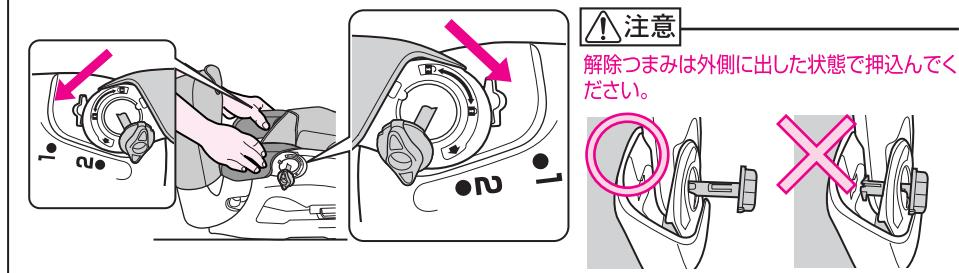
18 正面から座面カバーをかぶせ、座面側面(左右2ヶ所)と後側(2ヶ所)の穴に、カバーのピンをそれぞれ差込みます。
