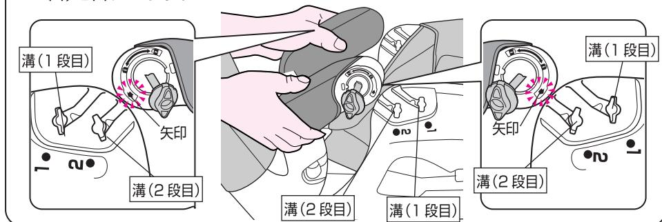
22 左右の角度調節パーツの青色の矢印を背もたれの溝に沿って押込みます。
