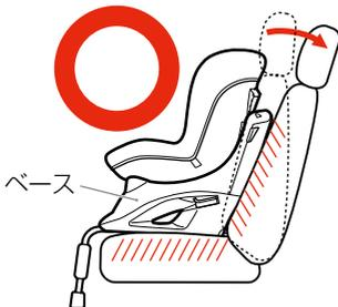
車のシートにリクライニング機能がない場合は、ベース底面を座面に密着させてください。
