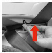
③ ベルトSTOPパーを押し込み、確実にロックする。
