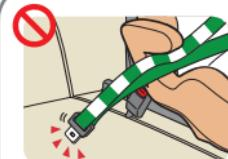
ISOFIX取付金具で本品を取り付けた状態で、シートベルトのバックルにタングを差し込むことができない
