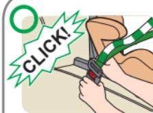
ISOFIX取付金具で本品を取り付けた状態で、シートベルトのバックルにタングを差し込むことができる
