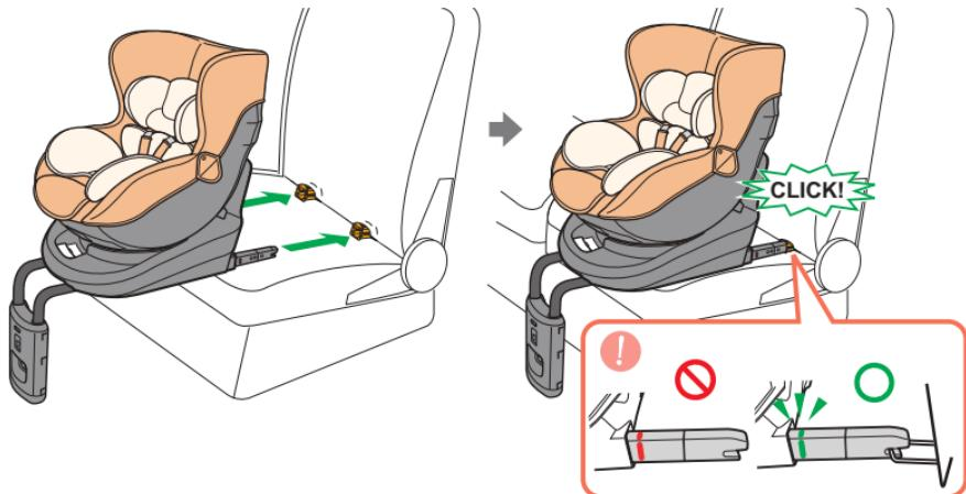
チャイルドシートを座席に乗せ、左右両方のコネクタ部を座席のISO FIX取付金具に力ちと音が鳴るまでしっかりと押し込む。
