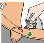
①バックルの解除ボタン(赤いボタン)を下に押して、タングを外す。
