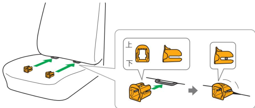
\* ISO FIX取付金具は座席に隠れて見えにくいため、フィックスガイドを使うことで、チャイルドシートが取り付けやすくなります。
