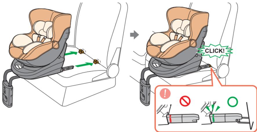
チャイルドシートを座席に乗せ、左右両方のコネクタ部を座席のISO FIX取付金具にカチッと音が鳴るまでしっかり押し込む。
