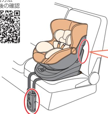
② サポートレッグと床面に隙間がなく、確実にロックされている。
